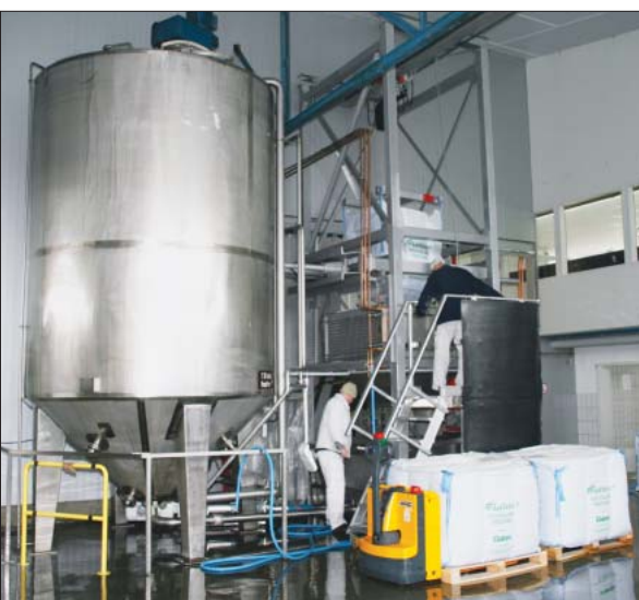
Im Sommer 2006 wurde eine Spezialmaschine konstruiert, die 1 000 kg Big Bags aufricht und die „Konglomerate“ über eine hydraulische Presse und einen Klumpenbrecher zerkleinert. Erst dann gelangt die kristalline Form in den Lösetank zur weiteren Verarbeitung.
