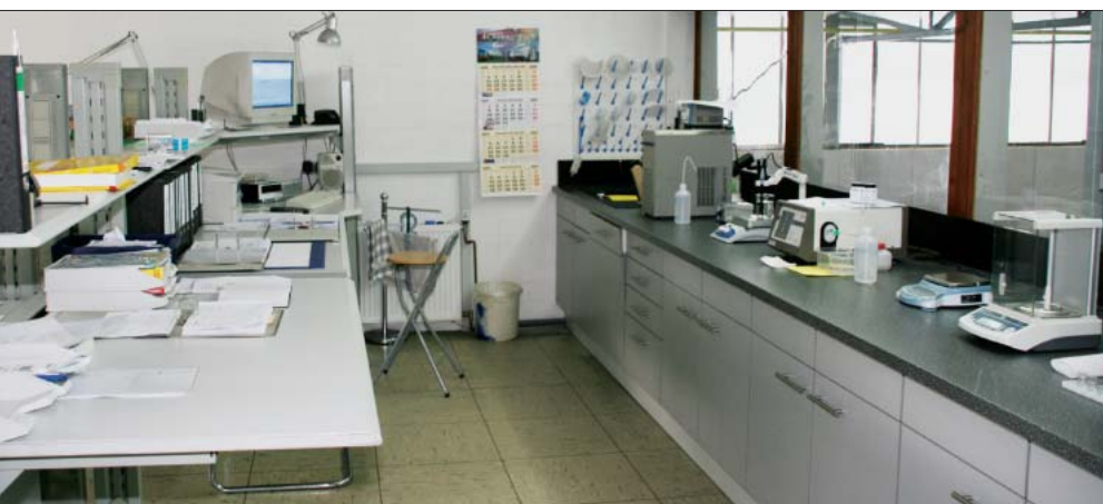
Die Qualitätsparameter der fertigen Sirupe, wie Trockensubstanzgehalt, pH-Wert oder Farbe, werden im Betriebslabor unter der Leitung von Dipl.-Braumeister Olaf Köwing überwacht.
